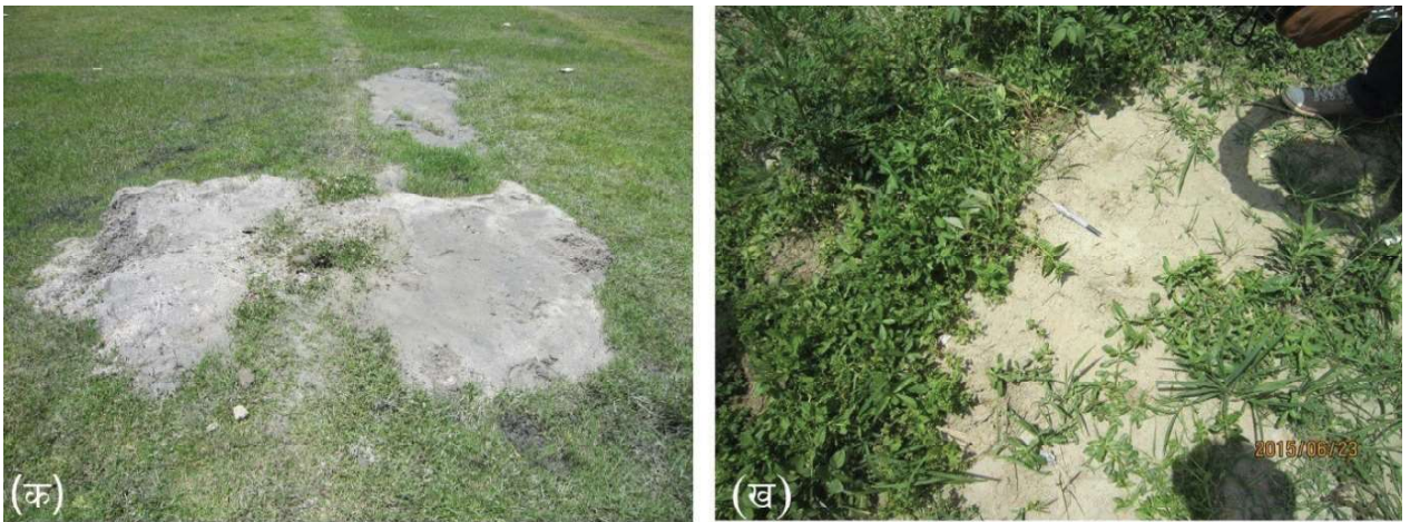
चित्र नं. ३.७ : गोरखा भूकम्पले काठमाडौं उपत्यकामा गरेको जमिनको तरलीकरण । (क) पुकुने पाटी, भक्तपुर (ख) इमाडोल, ललितपुर(सैजन्यः दीपक चम्लागाई) ।
