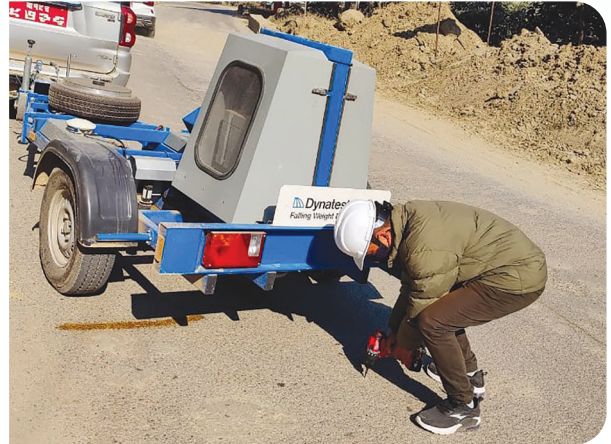
सडक विभागबाट खटिएको टोली पूर्व-पश्चिम राजमार्गको धानखोला-लमही खण्डमा फलिङ वेट डिफ्लेक्टोमिटरको प्रयोग गरी सडकको डिफ्लेक्सन मापन गर्दै ।
